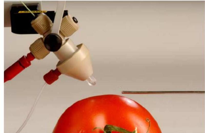
Schematische Darstellung der Desorptions-Elektrospray-Ionisations (DESI) Quelle
